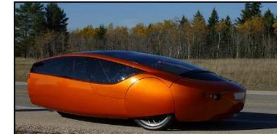
Véhicule hybride électrique. Tout en I3D (ABS), à l'exception du châssis et du moteur
