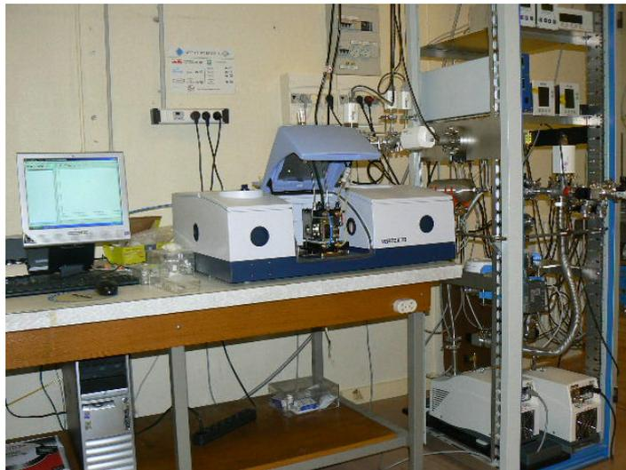
FIGURE 2.6 – Photographie du dispositif expérimental avec à droite le système d'introduction et d'évacuation des gaz de réactions. Au centre du spectromètre, dans le compartiment de l'échantillon la cellule PRONEXT (capot ouvert ici pour la photo).
