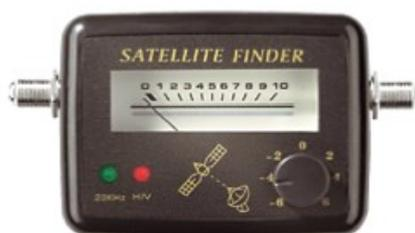
Figure 2: Pour information: image d'un SatFinder avec détection du 22kHz à **éviter absolument** puisqu'il module en fréquence (à moins de savoir où se trouve le module de modulation de fréquence et de le déconnecter). Noter les leds rouge et verte qui les différencient des SatFinders de base.
