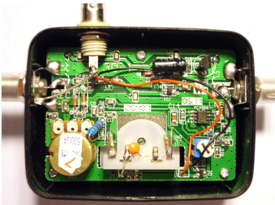
Figure 3: l'intérieur du SatFinder, avec la modification de la sortie BNC déjà incluse. La prise BNC est au dessus, et est alimentée par les câbles noir (relié à la masse) et rouge qui initialement alimentaient le buzzer. Noter que le circuit imprimé indique la référence "SF 30-1".
