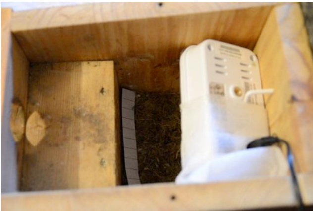
A gauche : caméra installée définitivement (calée, avec une protection, et avec un chemin de câble pour la sortie) et petite mire graduée en centimètres. A droite : image correspondante de la caméra (sur la tablette).
