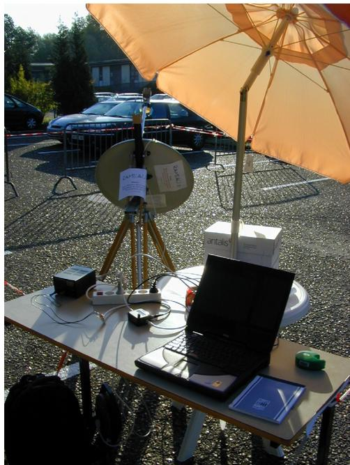
Figure 6. Le système d'acquisition de RAMEAU0 : l'antenne et LNB (arrière-plan), alimentation et SatFinder (à gauche), carte d'acquisition (cachée) et PC (à droite).
