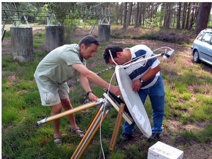
Figure 3. Tentatives de pointage sur le sol, lors d'un séjour à la station de Radioastronomie de Nançay (Cher) en Juillet 2005, par l'auteur et Bertrand Flouret (dont l'aide est déterminante au succès du projet). A l'issue de ce test, la fixation et l'orientation de l'antenne ont complètement été repensées. (Photo : P. Audureau)
