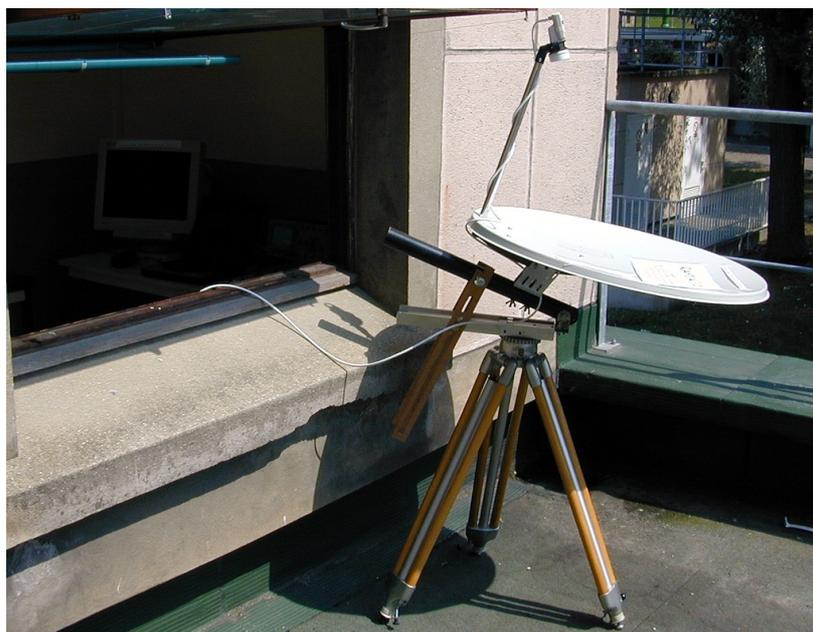
Figure 2. Première mesure avec le système complet RAMEAU0 en Août 2005. L'acquisition s'effectue sur le PC dans le bureau. Noter que nous avons opté pour une monture altazimutale, plus simple d'utilisation.
