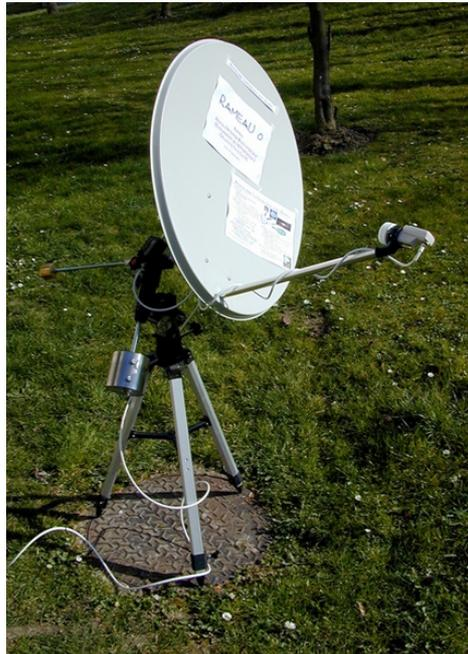
*Figure 1. RAMEAU0 observe le Soleil pour la première fois en Mars 2005. Il n'y avait pas d'acquisition sur PC dans cette configuration, et nous utilisons une monture équatoriale, peu pratique.*
