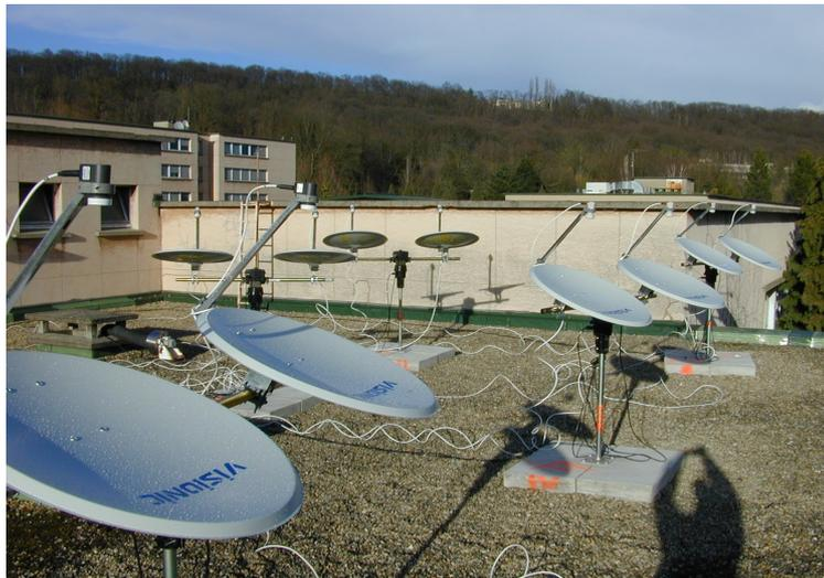
Les 10 antennes composant le réseau de radiotélescopes 10 GHz RAMEAU à Orsay. Photo H.D.
