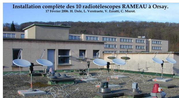
Figure 2: Vue des 10 radiotélescopes RAMEAU (Réseau d'Antennes Micro-Onde pour l'Enseignement de l'Astrophysique à l'Université Paris Sud 11) nouvellement installés en Février 2006. Les étudiants de L2 (et bientôt M1 et M2 Pro) utilisent RAMEAU pour observer le Soleil et la Lune à 10 GHz.
