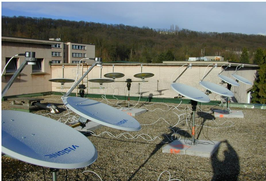
Les 10 antennes composant le réseau de radiotélescopes 10 GHz RAMEAU à Orsay. Photo H. Dole
