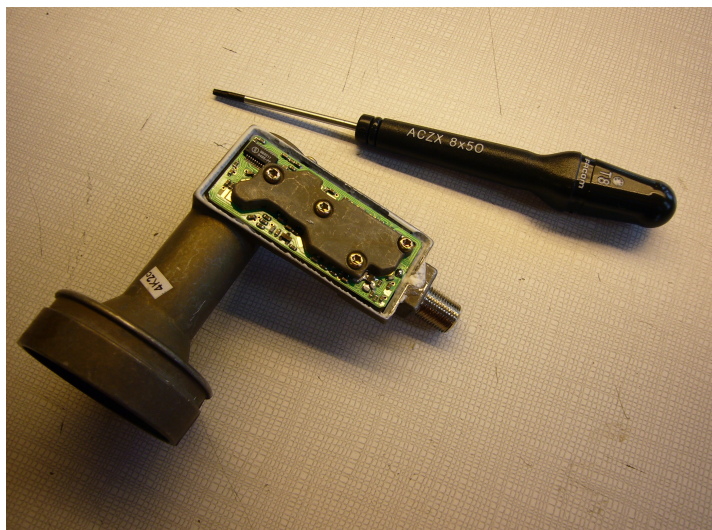
Figure 5: le capuchon métallique s'enlève en grattant un peu le mastic avec un cutter, et en faisant levier pour le dégager. Le circuit électronique est partiellement visible, puisqu'un cache vissé en protège l'essentiel. Il faut un tournevis torx de diamètre 0.8mm pour dévisser les 4 vis.
