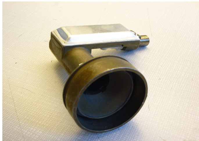
Figure 3: le LNB à nu: le guide d'onde est bien visible. Au fond, il y a deux antennes placées perpendiculairement. Le circuit électronique est protégé par un capuchon métallique collé avec une sorte de mastic blanc et souple.
