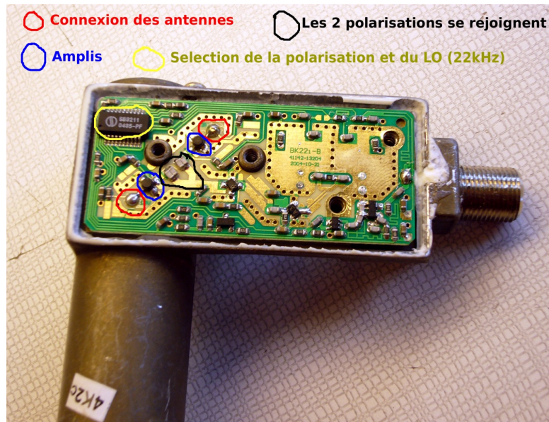
Figure 7: détails du circuit électronique.
