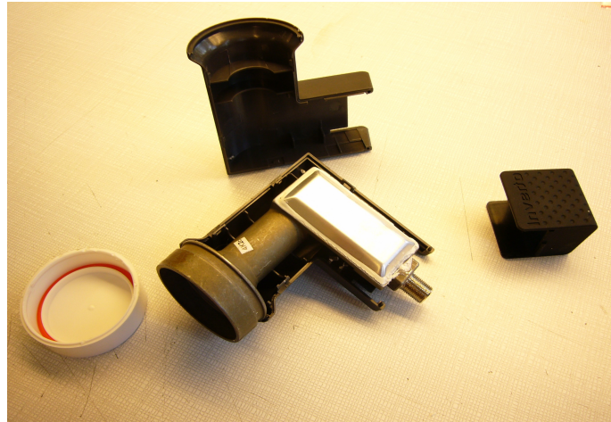
Figure 2: le LNB avec le capuchon et l'habillage en plastique enlevés à l'aide d'un gros tournevis plat. Le tout se remonte facilement en se clipsant.
